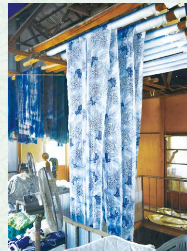
脱水した生地は干し竿に広げてかけ、乾燥させる。この後、厳密な検品を経て反物として出荷される。
