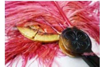
黄変し、ひび割れた20世紀初期のセルロイド製扇の柄（京都服飾文化研究財団所蔵）。
