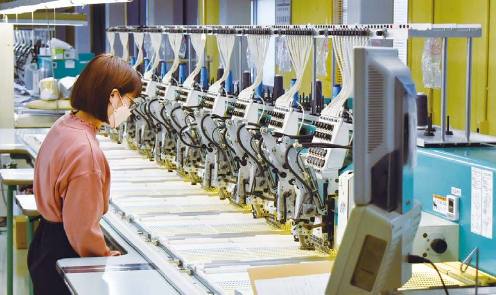
10台の刺繍機が同時に動くなか、糸の調子や刺繍にエラーがないか、進み具合に目を光らせる。
