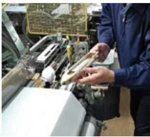
写真⑤「製織」の工程。経糸と緯糸を織機で織りあげていく
