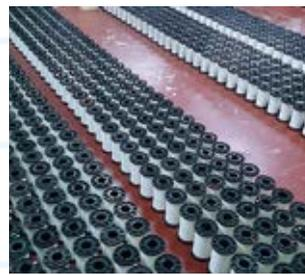
写真①「ワク立て」の工程。これら数百のボビンから糸を集め、経糸を「整経」する。本写真は定番の「ワク立て」
