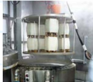
写真② 絹糸を熱水で煮る「緯煮き」の工程
