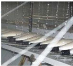
写真③「八丁撚糸」の工程。糸が切れないように水を掛けながら糸を撚っていく
