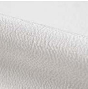
出荷前の製品。経糸と緯糸の加工の仕方で出来上がりのシボの太さや高さが大きく変わる
