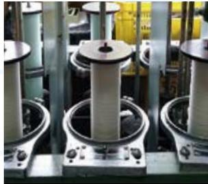
写真④ 八丁撚糸とカベ糸を合わせ、緯糸を作る「上撚り：合撚機」の工程
