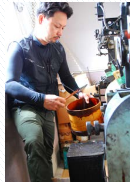
(上) 乾燥させるため室内に吊るした漆塗布後の125メートルの和紙 (右) 漆の硬さを調整し、機械に通した和紙に慎重に塗布する服部さん
